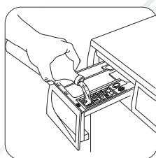
Вытяните до упора дозатор моющих средств. Отмерьте нужное количество моющего средства, засыпьте его в отделение основной стирки дозатора и, если Вы желаете выполнить предварительную стирку или вымачивание, засыпьте его в отделение, помеченное символом .
