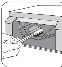
После снятия дозатора с помощью маленькой щетки прочистите отсек, в котором он находился, тщательно удалив все остатки моющих средств из его верхней и нижней части.
